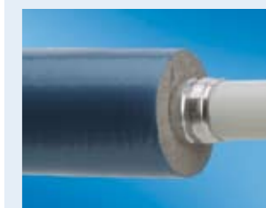
Izolavimas - užpresavus jungtį, nelieka jokių atsikišusių dalių, todėl galima montuoti ištinę vamzdžių izoliaciją
